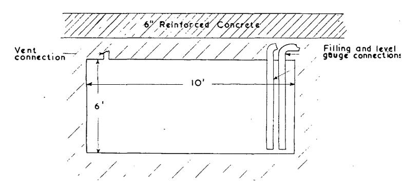
FIG. I. PROBABLE LAYOUT OF THE TANK BEFORE THE EXPLOSION.
