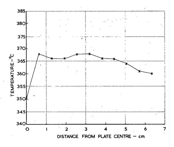
FIG.2. TEMPERATURE DISTRIBUTION OVER THE SURFACE OF THE BOILING PLATE.
