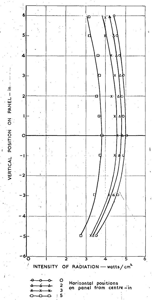
FIG.36. DISTRIBUTION OF RADIANT INTENSITY AT 8"
