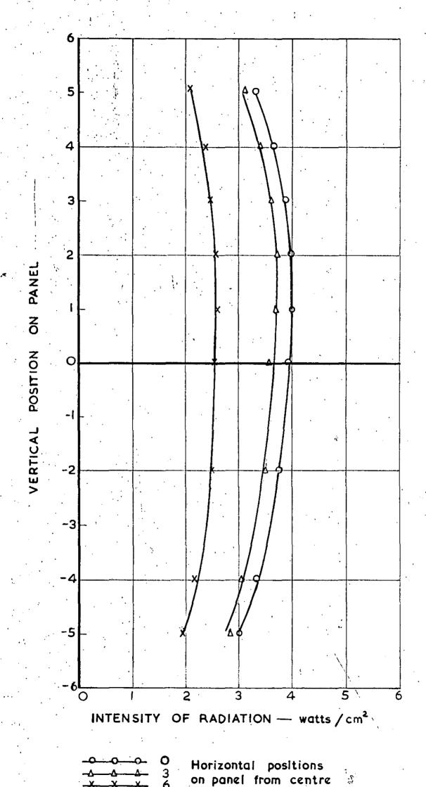
FIG.3c. DISTRIBUTION OF RADIANT INTENSITY AT 10"
