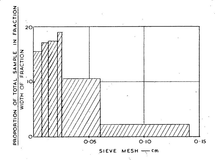
FIG. I. DISTRIBUTION OF PARTICLE SIZES. MIXED HARDWOOD SAWDUST
