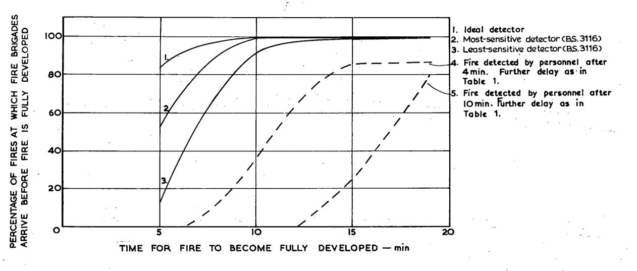
FIG. 3. EFFICIENCY OF AUTOMATIC FIRE DETECTORS - COUNTY BOROUGHS
