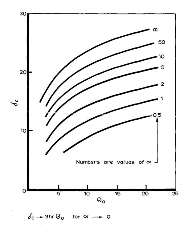
FIG. 6. CRITICAL  $\delta_{\rm C}$  FOR SPHERES — NEWTONIAN COOLING
