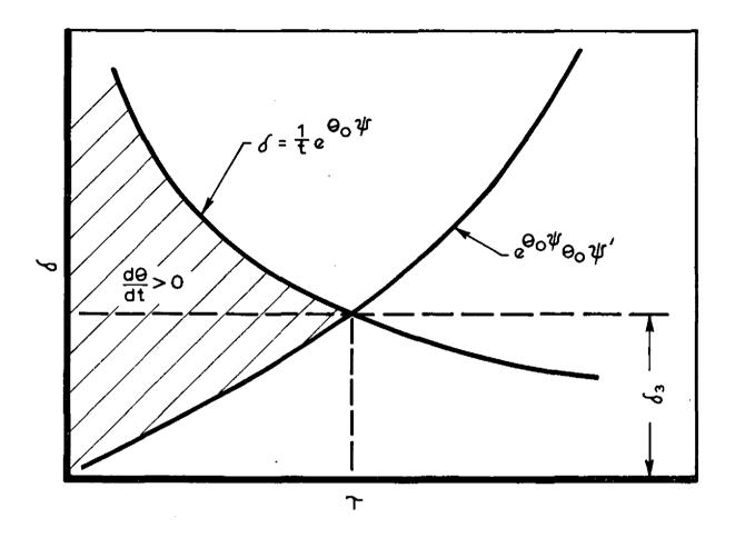
FIG. 4. THE SUFFICIENT CONDITION FOR IGNITION
