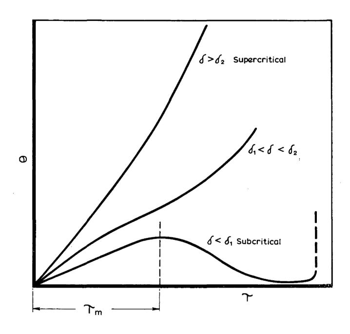
FIG. 3. TYPICAL TEMPERATURE-TIME BEHAVIOUR
