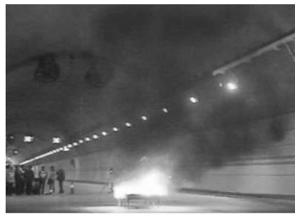
(d) test3, photo from downstream, after jet fan operation
